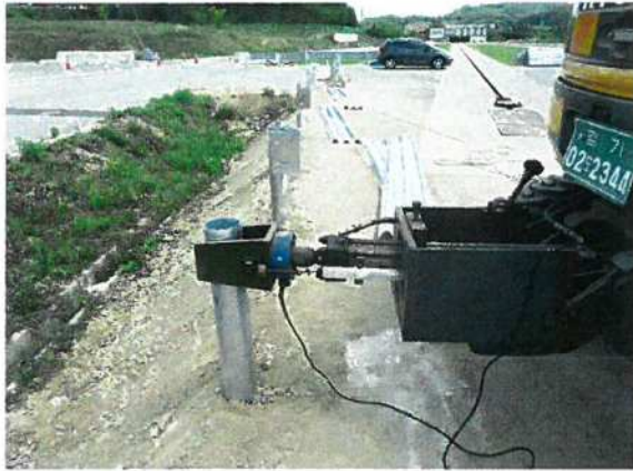
<지주 시험체 설치>
