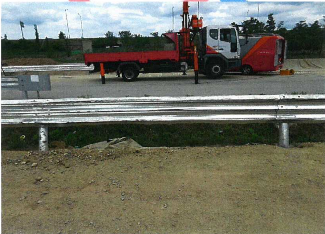
<대형차 시험 후 시설물 전면부>
