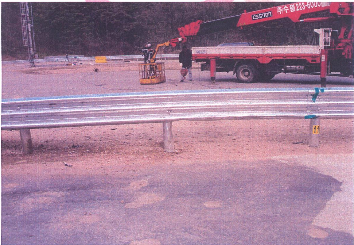
<소형차 시험 후 시설물 전면부>
