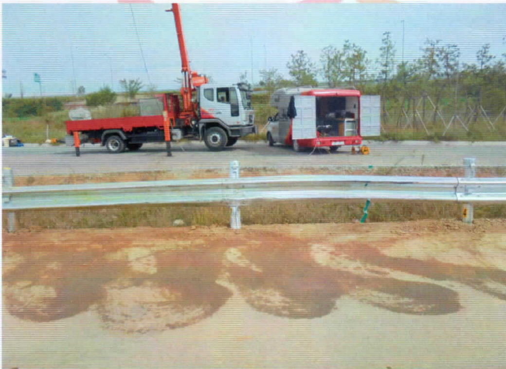
<소형차 시험 후 시설물 전면부>
