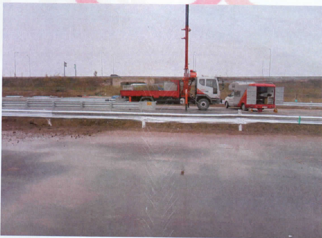
<대형차 시험 후 시설물 전면부>
