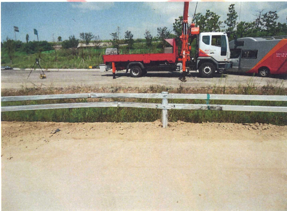
<소형차 시험 후 시설물 전면부>
