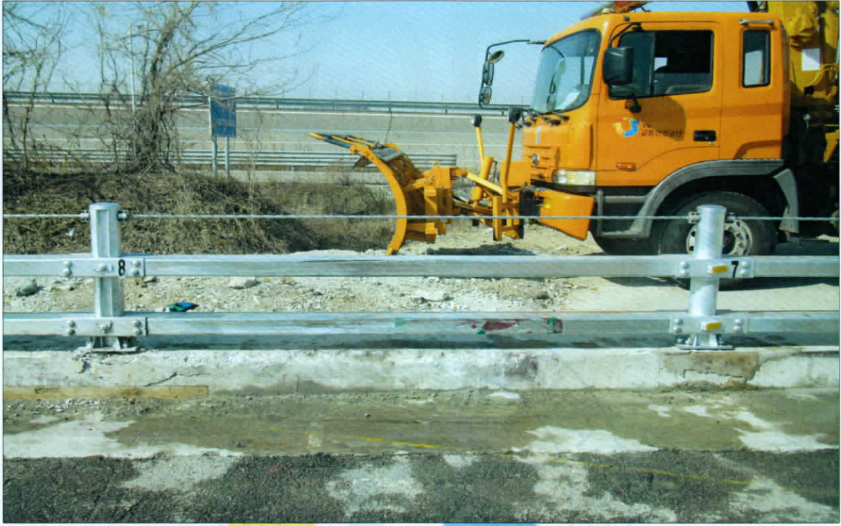
승용시험 - 시험 후 시험품 충돌부위
