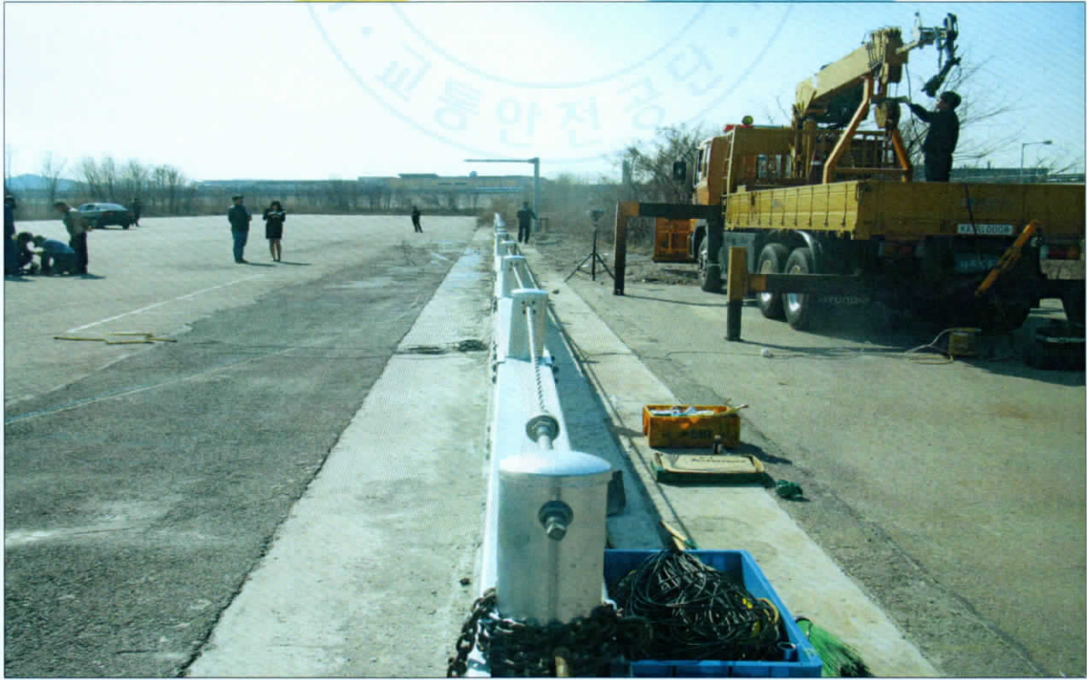
승용시험 - 시험 후 충돌차량 궤적 및 시험물의 구성 부재 분리·비산 상황 사진
